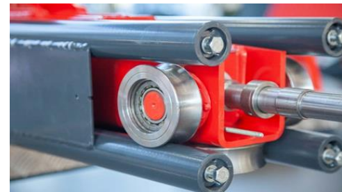
Płynna praca dzięki wózkom z łożyskami tocznymi
