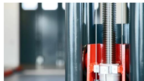
Walcowana na zimno i centrowana śruba nośna
