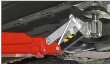
CF = końcówka łapy typu Combiflex
